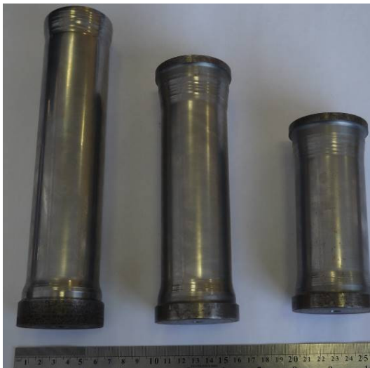
Рис. 3 - Деталі, які отримані ротаційним видавлюванням
