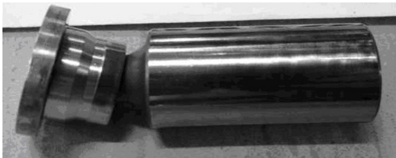
Рис. 1 – Плунжер з під'ятником аксіального гідравлічного насоса
